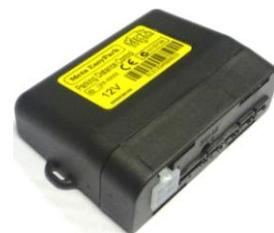
Il kit EasyPark è composto da una centrale che controlla quattro sensori passivi ed informa il conducente attraverso un altoparlante che emette una segnalazione acustica che incrementa la frequenza con l'avvicinarsi all'ostacolo.
